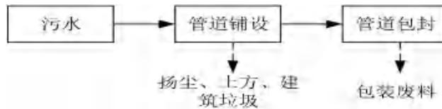
图 4-4 截污管道建设工艺图
